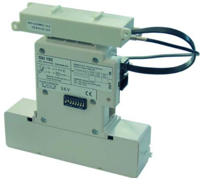
Uhrwerk mit GPS-Empfänger zur sekundengenauen Anzeige der Zeit. Die äußerst genaue Referenzzeit der Satelliten des GPS (Global Positioning System) wird verwendet, um die interne Quarzuhr des GU 192 periodisch zu synchronisieren.
