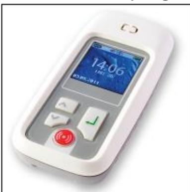
Falls Personal Unterstützung benötigt oder in eine Bedrohungssituation geraten ist, ermöglicht der **mobile Rufempfänger** auch das Senden eines Notrufes an alle in Reichweite befindlichen anderen Rufempfänger. So kann jederzeit und schnell die nötige Unterstützung herbeigerufen werden.
