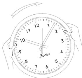
Als der Träger am Wand befestigt ist, drehen Sie eine viertel die Uhr im Uhrzeigersinn, um sie in ihrer richtigen Position zu hängen.
