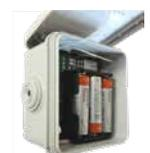
Lufttemperaturfühler mit Batterien (Funkverbindung)
