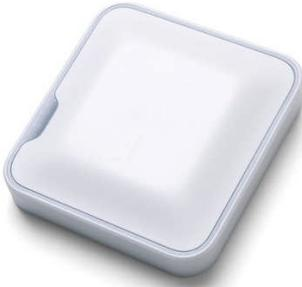
Der **Reichweitenverstärker** berücksichtigt wahlweise alle empfangenen Signale oder nur die von vorprogrammierten Funksendern. Es können bis zu 8 Sender fest einprogrammiert werden. Das Gerät kompensiert Funkkollisionen. Mitgeliefert werden ein Steckernetzteil und ein Akku, der bei Stromausfall einspringt.
