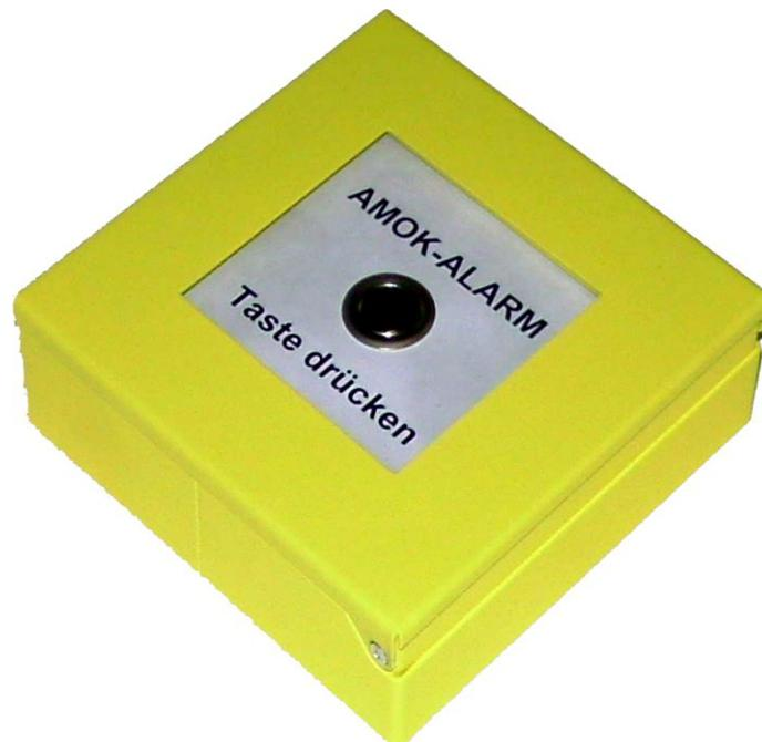
Der **Telefon-Druckknopfmelder UniSignal MF** wird wie ein normales Telefon an eine analoge Nebenstelle einer Telefonanlage angeschlossen. Wird der Alarm durch Einschlagen der Schutzscheibe und Druck der Taste ausgelöst, wählt der Druckknopfmelder automatisch eine einprogrammierte Rufnummer an. Bei Annahme des Notrufes mit einem Telefon kann zur Verifizierung des Notrufes in den Raum hineingehört werden.
